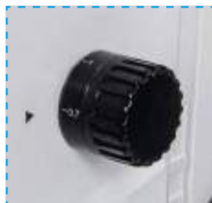
Выбор оптического увеличения зум-объектива
