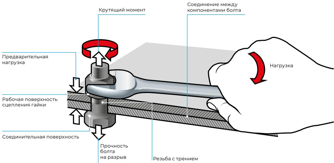
На рисунке показано крепление двух металлических листов (прижатие друг к другу) с помощью разъемного болтового соединения путем затягивания одной гайки. От угла шага резьбы зависит достигаемое тяговое усилие, возникающее в болте. Усилие поворачивания вызвано тяговым усилием. Эта предварительное тяговое усилие является определяющим фактором для оптимального болтового соединения.
