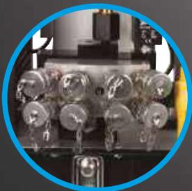
Двухконтурный распределительный коллектор с возможностью синхронной работы 4 гидравлических гайковертов
