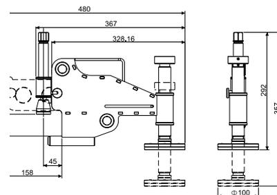
Выравниватель фланцев гидравлический со встроенным насосом NFAHM-10
